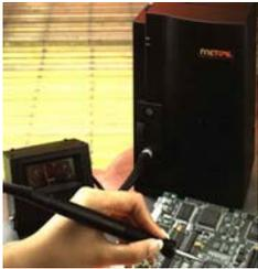
Las distintas uniones de soldado (y desoldado) requieren distintos niveles térmicos. Para dicha compensación, los soldadores convencionales varían la potencia a partir de la medición de la temperatura en la punta, con este método, la estabilidad exacta de la temperatura bajo régimen de trabajo intensivo (o en el soldado y
